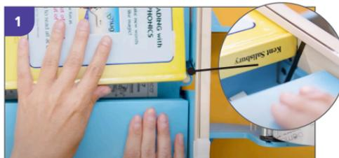
Appuyez sur la plate-forme et faites glisser le livre sous la lèvre du massicot, le dos tourné vers la droite. Alignez le coin inférieur du dos du livre sur le guide du dos.
